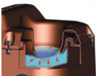
Le bol transmet la chaleur contenue dans la réserve d'eau et résiste à - 15 °C
